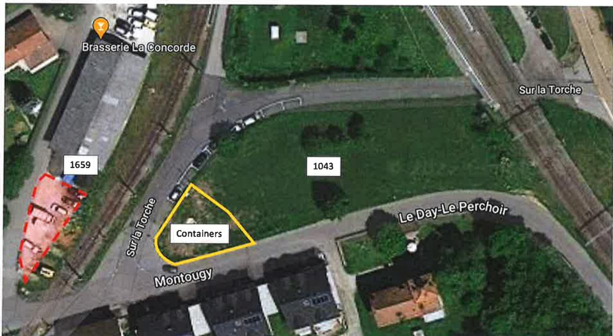
Les travaux principaux consistent en l'aménagement d'une surface en béton pour les containers, d'une paroi en bois pour cacher les containers à ordures ainsi que d'un accès en revêtement bitumineux avec la récolte des eaux de pluie.
